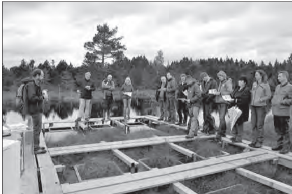
Über diese Rahmen werden die Messhauben gestülpt
